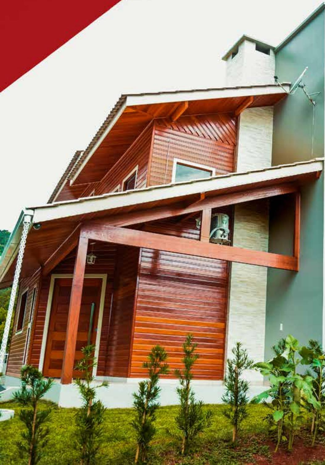
Nas casas de madeira, a cada dois anos, recomenda-se passar uma lixa para tirar o brilho do verniz e, em seguida, aplicar uma nova camada do produto na parte externa, isso pelo fato da incidência de raios solares na madeira.
